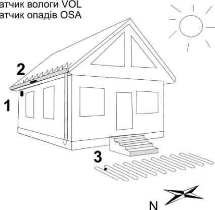
Рисунок 1. Розміщення датчиків температури повітря, вологості та опадів
